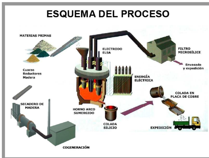
**Figura 1:** Esquema del proceso de fabricación del silicio y microsíllice en la fábrica de Sabón, A Coruña
